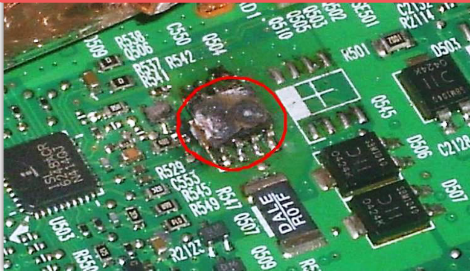
Figura 1. Tablero electrónico con un dispositivo electrónico dañado por corrosión. Fuente: http://reparatarjetas.blogspot.mx/p/reparacion-de-tarjetas-electronicas.html
