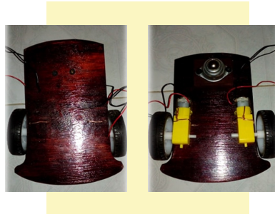
Figura 3. Imagen de la estructura mecánica del robot seguidor de línea con sus motores de corriente directa acoplados al chasis del móvil.
